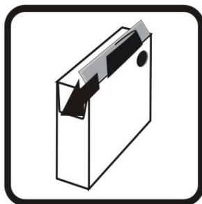
[486] Entfernen der Schutzfolie des Klebestreifens
