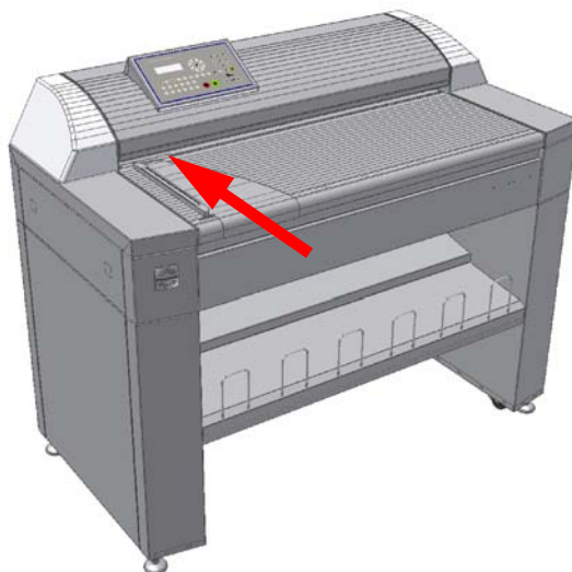
[201] Einlegen einer Vorlage in den ROWE Netzwerkscanner
